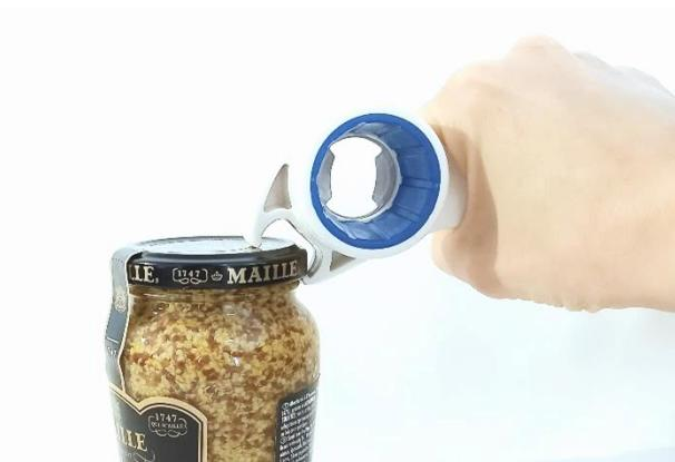
Facilite l'ouverture des bocaux munis de couvercles à vis en cassant le vide. Pour ce faire, placer le crochet sous le couvercle et tirer le décapsuleur vers le haut jusqu'à ce que le vide soit cassé.
